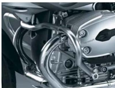
Der robuste Motorschutzbügel bietet, mit seiner stabilen Rohrkonstruktion aus Edelstahl, auch abseits befestigter Straßen Schutz vor Beschädigungen im Zylinderbereich.
