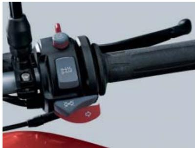
Die in zwei Stufen schaltbaren Heizgriffe sorgen auch bei extremer Witterung für warme Hände.
