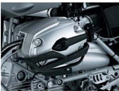
Der Zylinderschutz aus glasfaserverstärktem Kunststoff ist in erster Linie für den Einsatz auf der Straße konzipiert und schützt die Zylinderkopfhaube vor Beschädigungen.
