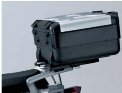
Das ebenfalls wassergeschützte Vario-Topcase lässt sich mit Hilfe der Adapterplatte auf der serienmäßigen Gepäckbrücke befestigen. Das Volumen kann wie bei den Vario-Koffern mit einem Bügel im Inneren einfach und schnell von 25,5 l auf 32,5 l vergrößert werden
