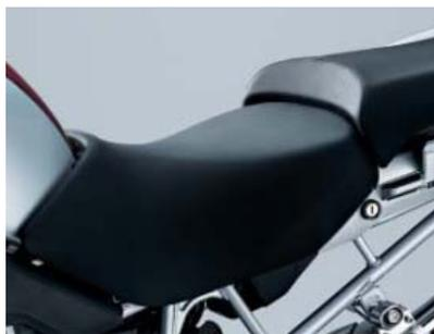
Als Zubehör hat BMW Motorrad für die R 1200 GS zwei zusätzliche Fahrersitzbänke im Programm. Der verstellbare Fahrersitz hoch (880 mm bis 900 mm) und der Fahrersitz niedrig (820 mm). Zusammen mit der verstellbaren Serien-Fahrersitzbank (840 mm bis 860 mm) wird eine Sitzhöhenpreizung von 820 mm bis 900 mm erreicht – einmalig in der Motorradwelt. Alle Sitzbänke sind jeweils in schwarz oder grau erhältlich.
